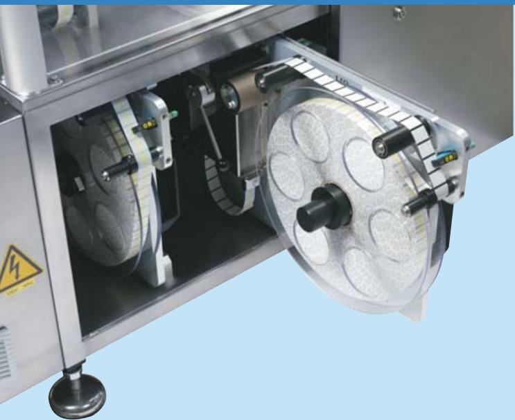
LABEL REEL HOLDERS SLIDING ON RAILS FOR LABEL REEL MANUAL CHANGE VERTICALLY POSITIONED INSIDE MACHINE BASEMENT; THE HOLDERS ARE COMPLETE WITH AUTOMATIC DE-REELING AND SENSORS FOR LABEL REEL-END DETECTION.
